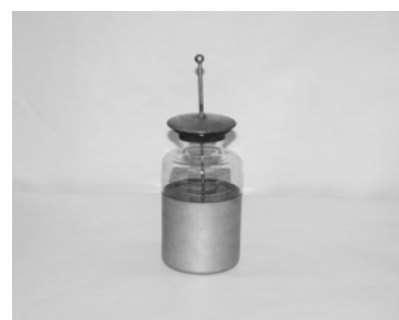
ライデン瓶 (Leyden jar) 図書: 円柱コンデンサーの一種。ガラス瓶の内外両面に金属箔を貼りコンデンサーを構成している。高圧の静電気を蓄えるのに用いられる。
